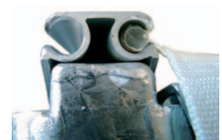
Einzug aller Planen wasserdicht in Kedernuten
